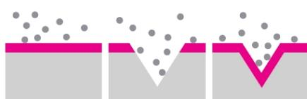
В результате контакта с кислородом из окружающей среды (воздух, вода или другие среды) на поверхности нержавейки образуется тонкий, в несколько слоев атомов, прозрачный слой оксида хрома. Слой защищает изделия из нержавеющего сплава от дальнейшего химического влияния. Если поверхность повреждена, пассивный слой создается автономно под влиянием кислорода.
